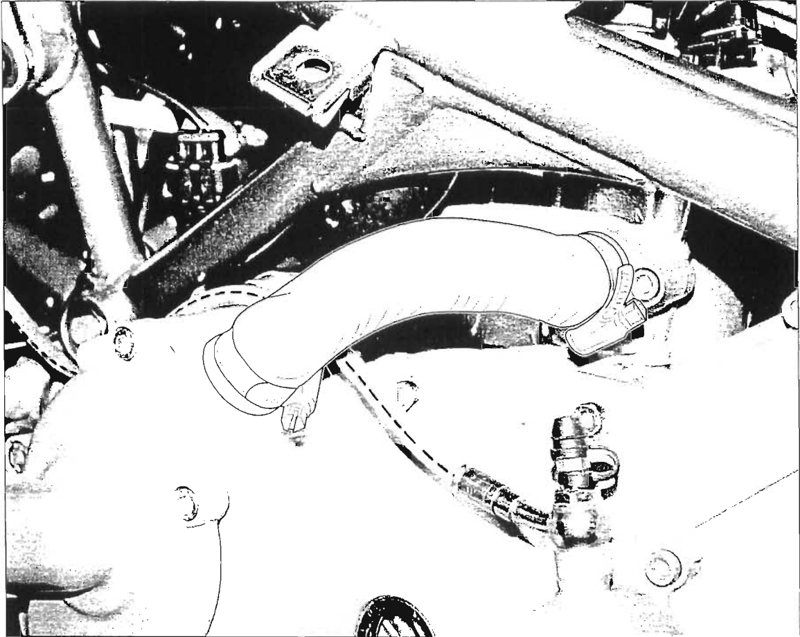
Posizionamento tubazioni impianto di raffreddamento motore.
